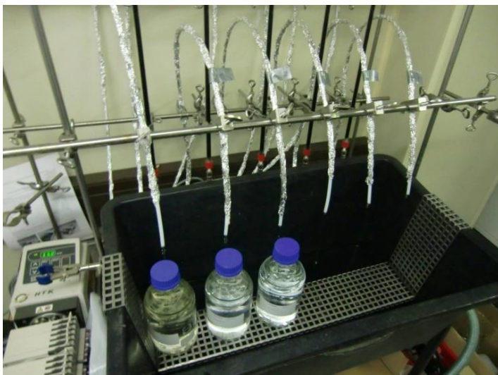
Bild 9: RSSCT-Teststand mit 5 RSSCT-Säulen (Hintergrund), digitale Mehrkanalschlauchpumpe (links), Probenahmestelle des Zulaufs und der 5 Säulenabläufe (Vordergrund) (HÖTTE, 2013)
