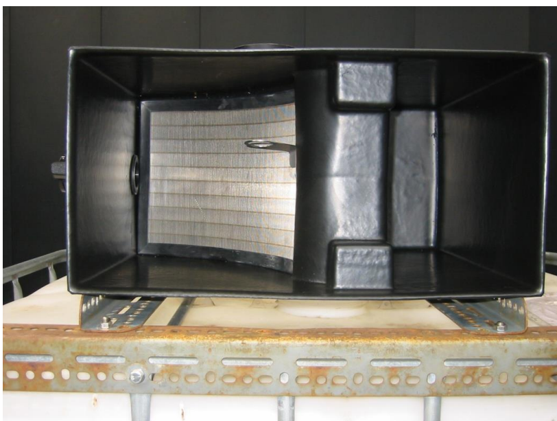
Bild 12: Nahaufnahme es den halbtechnischen Filtersäulen vorangeschalteten Bogensieb
