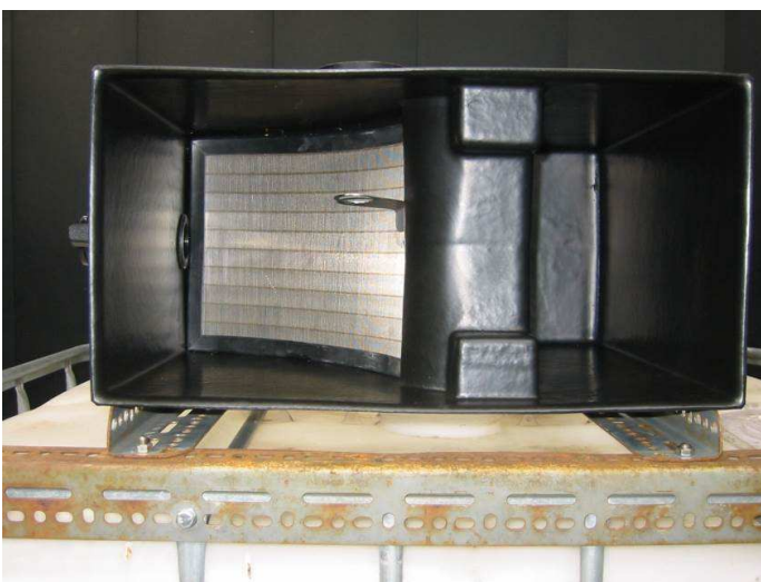
Bild 35: Verwendetes Bogensieb (Spaltweite 1 mm) zur Entfernung von Feststoffen im Zulauf der halbtechnischen Filter
