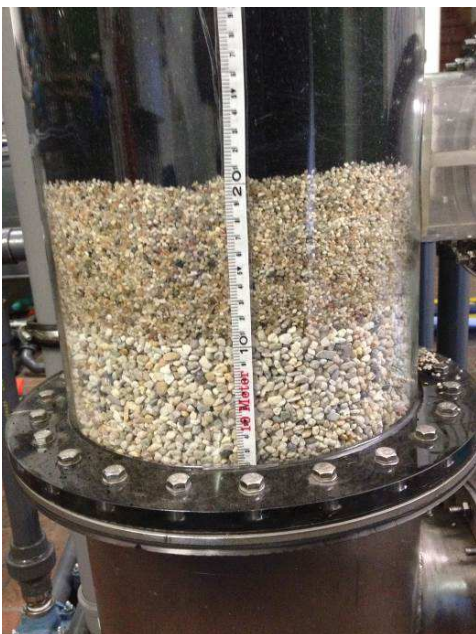
Bild 36: Aufbau der Stütz- und Filterschichten mit 10 cm Grobkies und 10 cm Feinkies als Stützschiicht sowie der darüber angeordneten GAK-Filterschiicht
