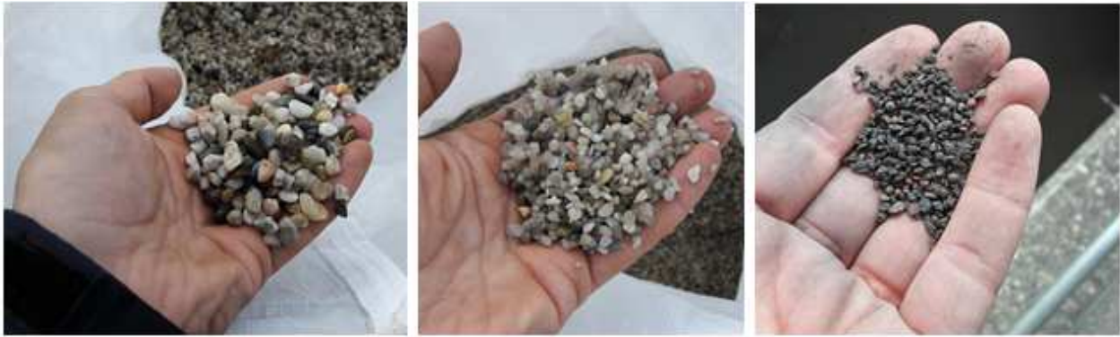
Bild 19: Stützschantz 1 (links), Stützschantz 2 (Mitte), Blähton (rechts)
