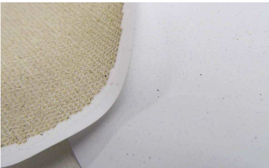
Bild 51: AFS im Zu- und Ablauf der halbtechnischen GAK-Filter in KRO
